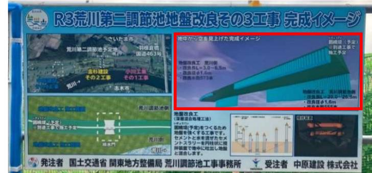
CIMモデルによる最終的な地盤改良後の工事説明看板を設置することにより、従来の2次元とは異なり3Dモデルによる可視化が促進され地域の方への工事理解に寄与しています。
